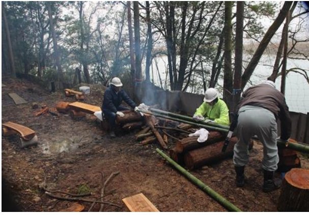
[2月15日] 竹のやに抜き作業の様子。竹林の除間伐でできた竹材を焚き火で焙り、やにを拭き取る「やに抜き」作業に挑戦した。
